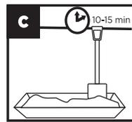
Deje reposar la mezcla por 10-15 minutos, esto activará componentes adhesivos de la mezcla.
