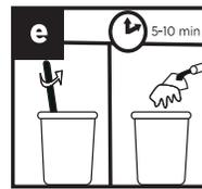
Deje reposar la mezcla por 5-10 minutos, esto activará componentes adhesivos de la mezcla.
