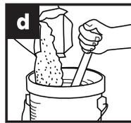
Agregue el contenido del saco poco a poco para que el polvo se integre al agua. Mezcle hasta obtener una pasta suave y homogénea.
