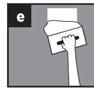
Aplique Cemix Pasta Fina Plus sobre el muro con una llana lisa. | Apply the mixture of Cemix Pasta Fina Plus with a flat trowel on the wall.
